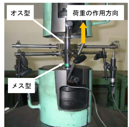
写-3 引抜き試験治具
