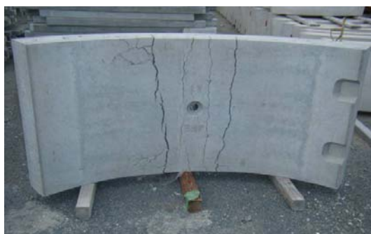
図-6 AFRC 供試体の破壊状況
