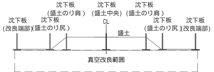
図-4 沈下量測定位置図
