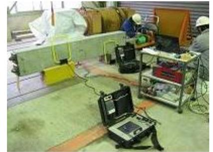
図-3 緊張導入時の測定状況
