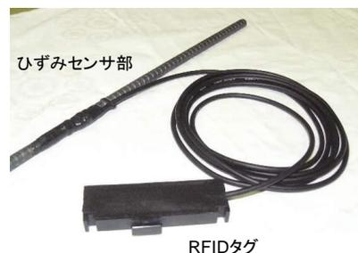
図-1 RFID ひずみ計測システムの計測部
