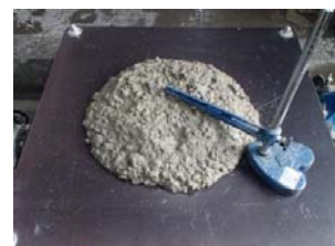
写真-1 中流動コンクリート
