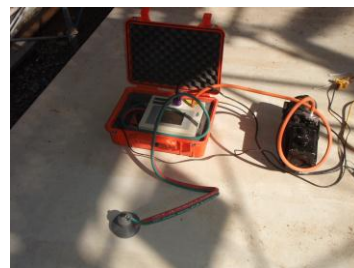
写真-3 トレント法透気試験状況
