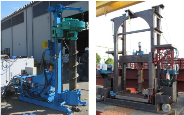
写真-2 施工架台(左：一般部用、右：狭隘部用)
