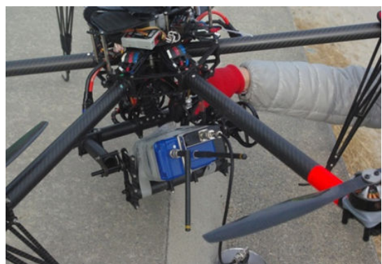
図-2 無線機の搭載状況
