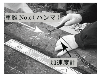
図-7 衝撃弾性波試験状況
