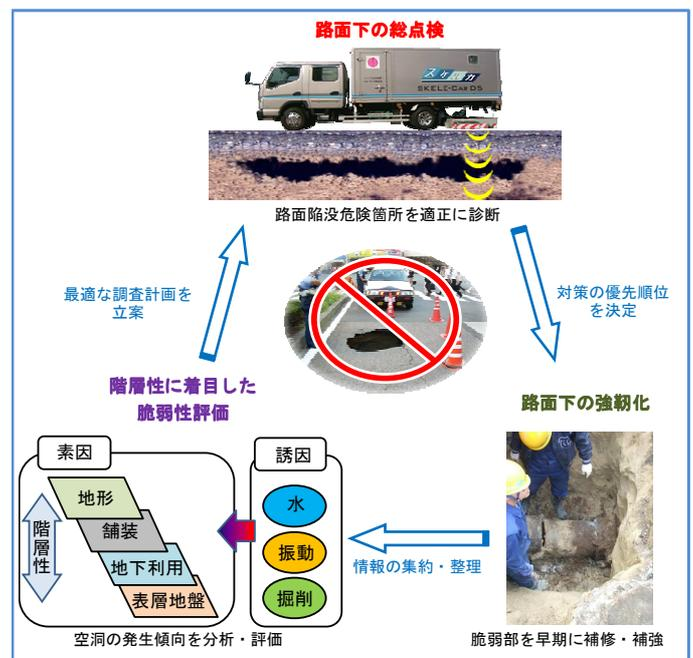
図-1 路面陥没防止に資するメンテナンスサイクルのスパイラルアップ
