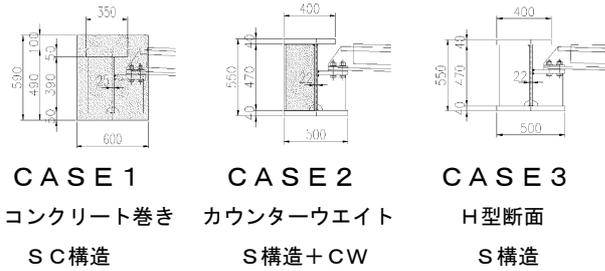
図—3 工事桁の検討断面
