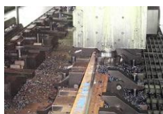
写真 1 頭部側面削り加工 写真 2 頭頂面こう配削り加工
