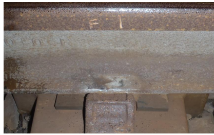
図 3 敷設 39 ヶ月後の Zn-Al 溶射
