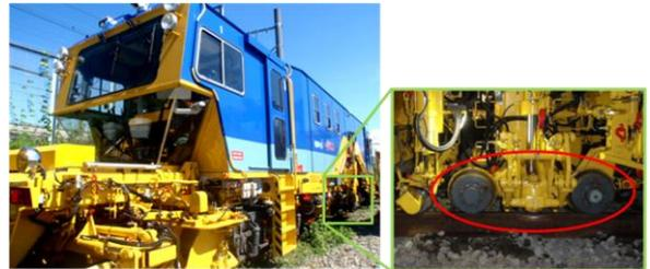
写真-1 新型バラスト整理車(KVP-S)と加振装置
