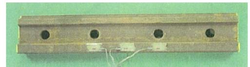
図-5 試験後の継目板
