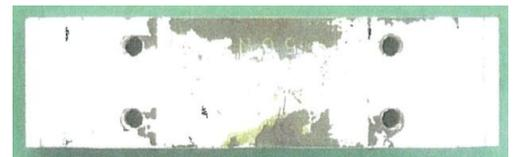
図-6 試験後のレール折損補強器-底板
