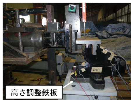
写真-2 部材強度確認試験
