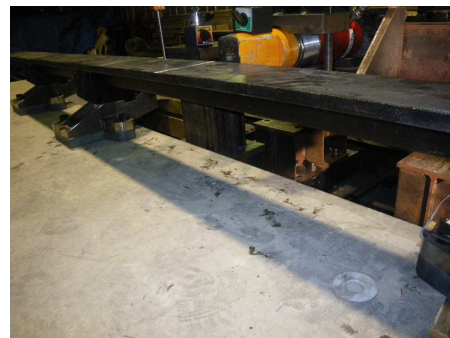
写真－2 軌きょう載荷試験（中間載荷）
