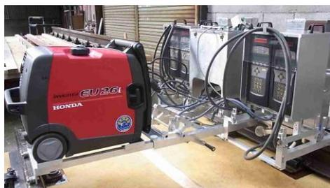
図3 スラブ軌道用多頭式ボルト緊解機
