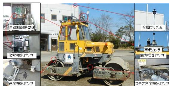
図-1 振動ローラと搭載センサ
