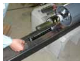
写真－3 センサ引き抜き状況
