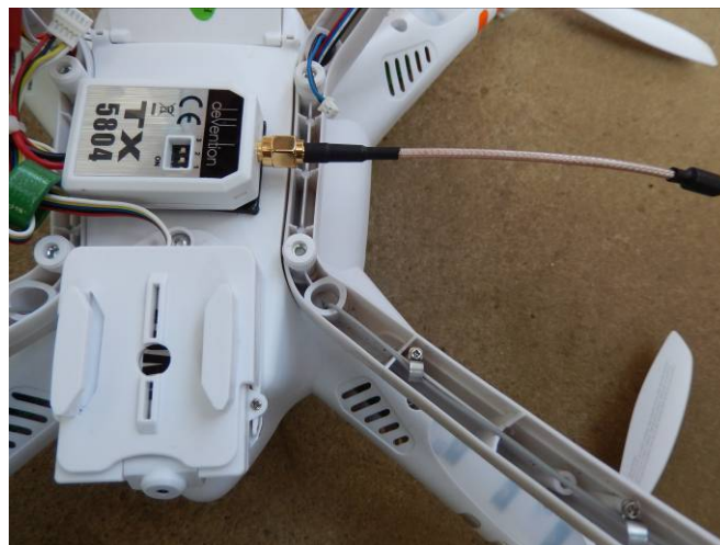
写真-3 5.8GHz 通信ユニットとカメラ取り付け例 (WALKERA QR X350)
