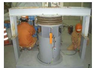
写真-2.1 一次元圧縮試験
