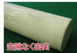
写真-1 透明型枠注入実験供試体
