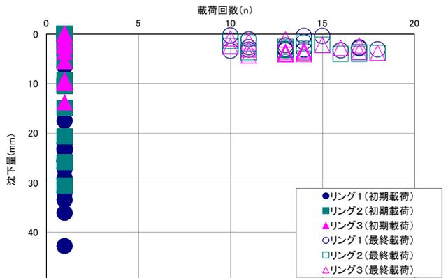
図-4 載荷回数と沈下量
