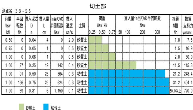
図-1 スウェーデン式サウンディング試験結果
