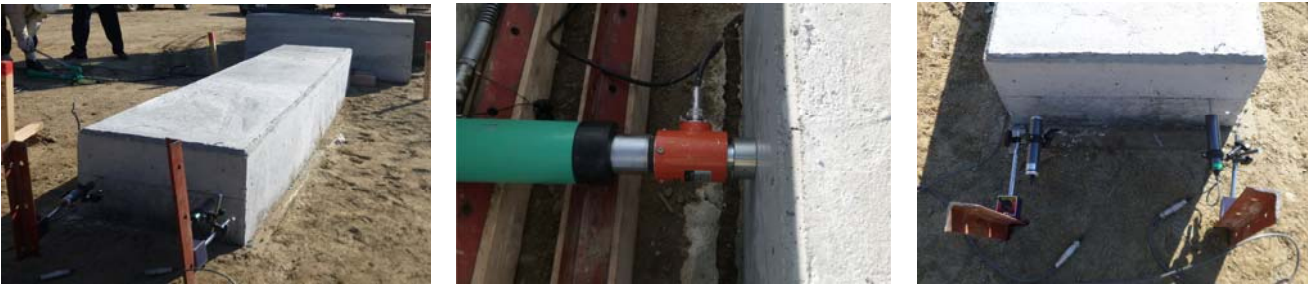
図 2 試験状況写真 (左図：供試体，中図：荷重載荷点，右図：変位計測点)
