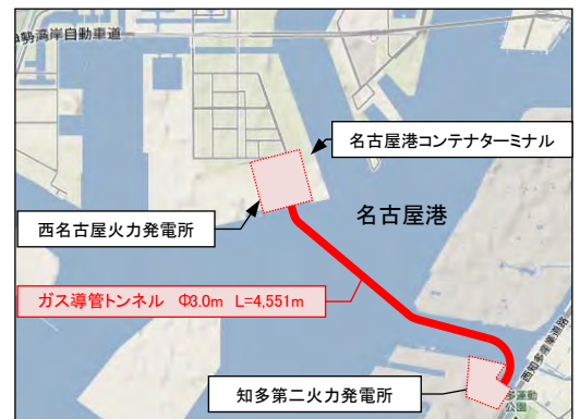
図－1 トンネル平面線形
