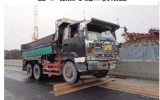
写真-2 振動実験載荷状況
