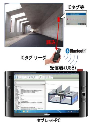
図-3 ICタグを活用したCIMデータの閲覧システム
