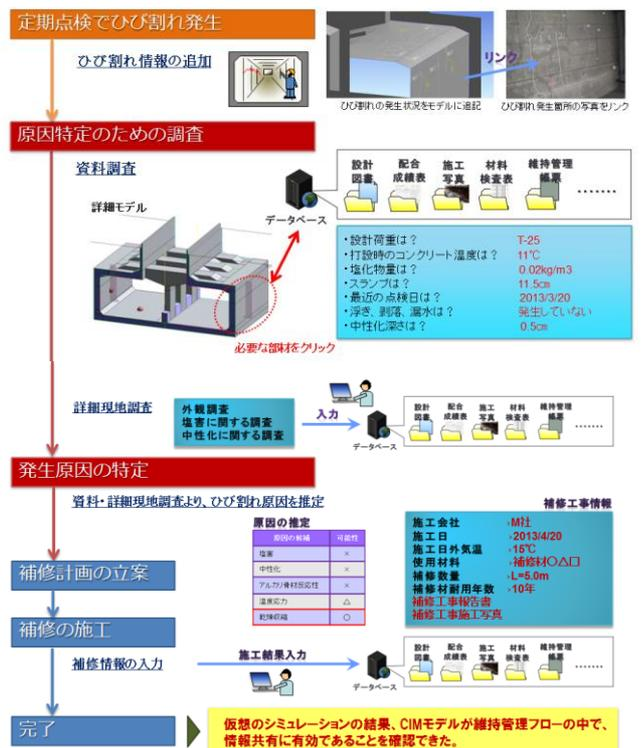
図-2 ひび割れ発生時の対応シミュレーション
