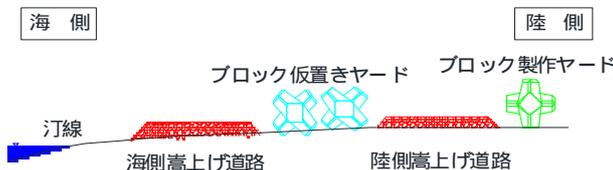
図-4 ブロック製作・仮置きヤード断面図
