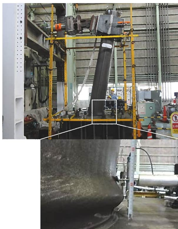
写真-1 Case4 最大荷重時座屈状況
