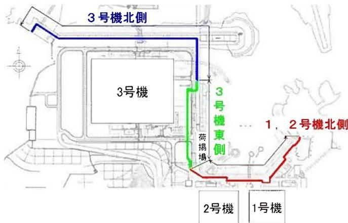
図-1 津波防波壁配置図
