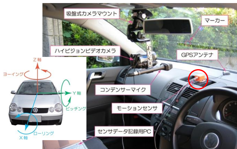
図-2 測定車両とセンサ設置(赤円内)状況
