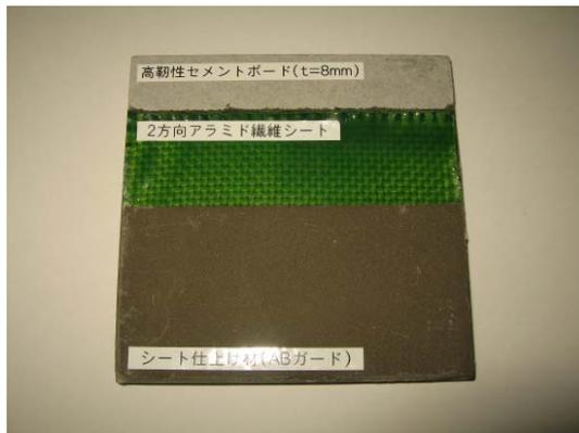
写真-1 薄型パネル構造
