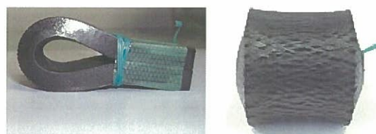
図 1 オゾン劣化後の試験片
