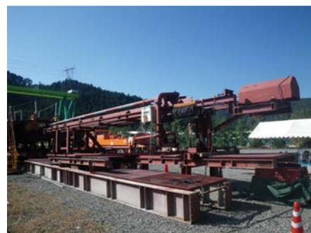
写真-1 引抜配管打設装置
