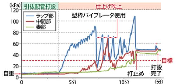
図-3 天端打設時の圧力結果
