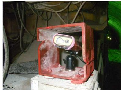
写真-2 レーザ距離計設置状況
