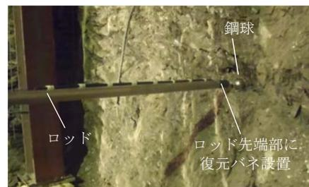
写真-2 切羽面での打撃状況
