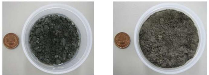
写真-3 浸水崩壊状況（左：当初、右：軟質化）
