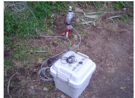
写真-1 データロガー、受振子設置状況
