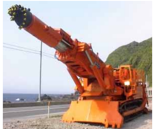
写真.2 300kW 級縦軸型掘削機(RH10J)
