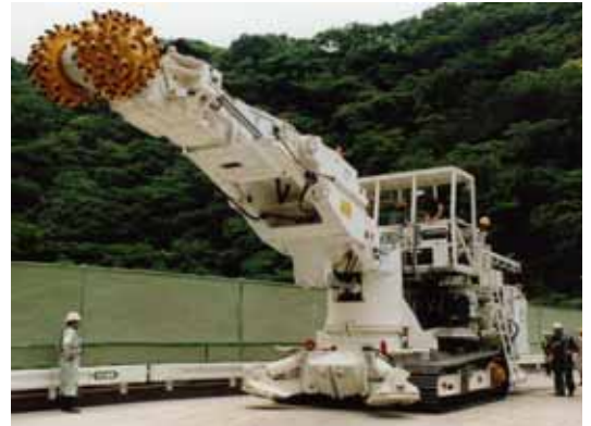
写真.1 300kW 級横軸型掘削機(WAV300H)
