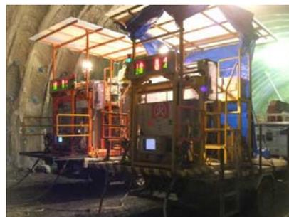
写真-3 爆薬の遠隔装填装置
