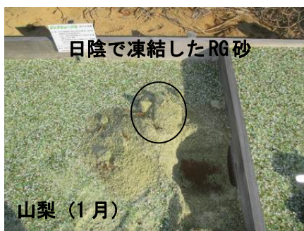
写真5. 凍結しても隆起しないRG砂
