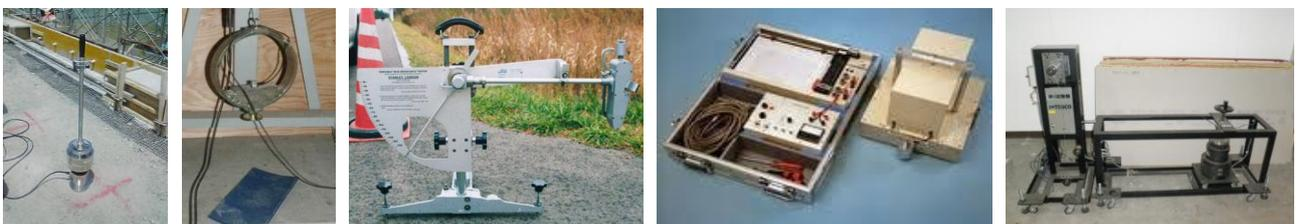
写真-1 左から小型FWD, 床の硬さ試験, 振り子式すべり抵抗試験, DFテスターSタイプ, 床滑り試験機
