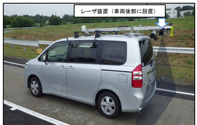
図-2 一般車両への設置状況
