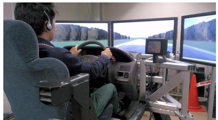
図-2 反応時間測定試験の様子
