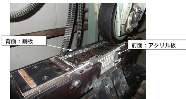
写真-2 クラック貫通試験状況
