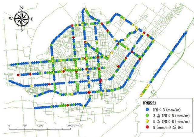
図-4 「総点検実施要領(案)【舗装編】」を参考にした *IRI* による路面モニタリング
