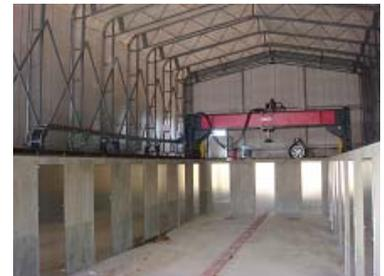
写真-1 繰返し载荷試験施設
