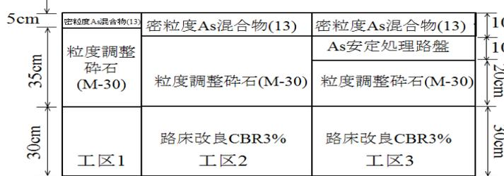
図-1 舗装構造体
