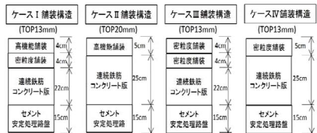
図-2 各ケースの舗装構造
