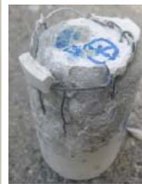
図-6 補強試験体破壊形態
