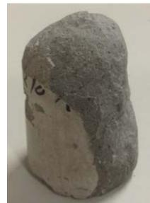
図-5 繰返し加圧後の楕円状破壊面
